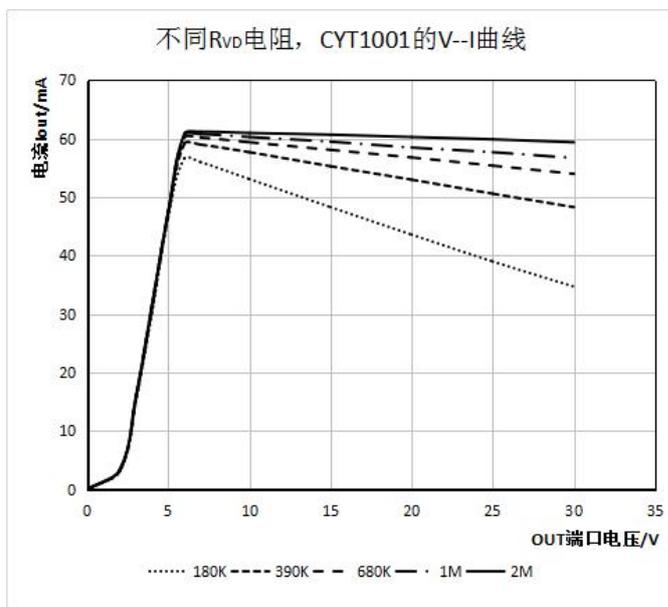
图 3.1 不同  $R_{VD}$  电阻，CYT1001 的 V-I 曲线
